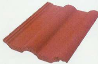
Kiremit: Çift oluklu profili fazla belirgin olmayan kıvrımlardan oluştuğundan, estetik hareketli bir yüzey oluşturur. Alt yüzey, çabuk ve kolay döşeyebilmenin yanı sıra, suyun tutulması ve hava sirkülasyonu sağlamak için en uygun formlarda tasarlanmıştır. Enine olan çiftli yuvarlak kanallar, sirküle eden havaya döne döne giden bir hareket kazandırdığından, suyun iki kiremit arasına girmesi halinde hızla boşalır ve kısa bir süre içinde kurutarak örtü altına geçmesini önler.
